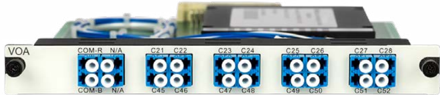
VOA (Variable Optical Attenuator) 4 ou 8 canais, é usado para ajustar a potência do sinal em redes ópticas
